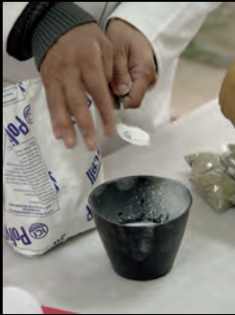
19 a: gips maýyşgak gapda taýýarlanylýar; b: gips ýuwaşlyk bilen guýulýar; ç: artykmaç gips kesilip aýrylýar (fotosy: E. Ottenwelteriň).
