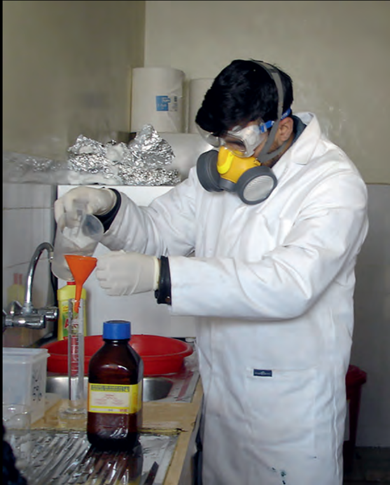
29 Kislota ulanylanda geýilýän gorag geýimi (fotosy: E. Ottenwelteriň).
